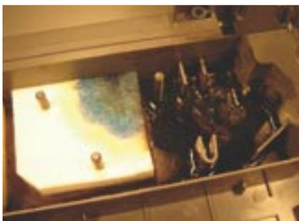
**Рис. 6.** Крупный план: служебный поддон струйного принтера. Сюда сливаются чернила при включении и плановой прочистке сопел
