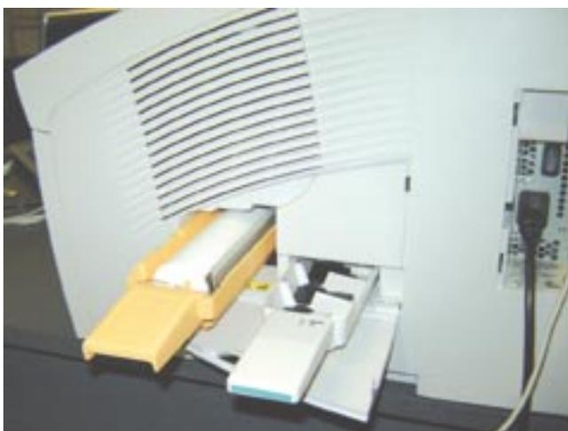
Рис. 4. Процедуры обслуживания Phaser 8500 всего две: сменить силиконовый вал и вытряхнуть поддон для отработанных чернил
