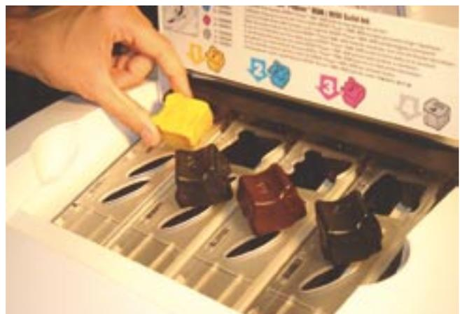
Рис. 3. Дозаправка принтера чернилами возможна в любой момент, в том числе и в процессе печати
