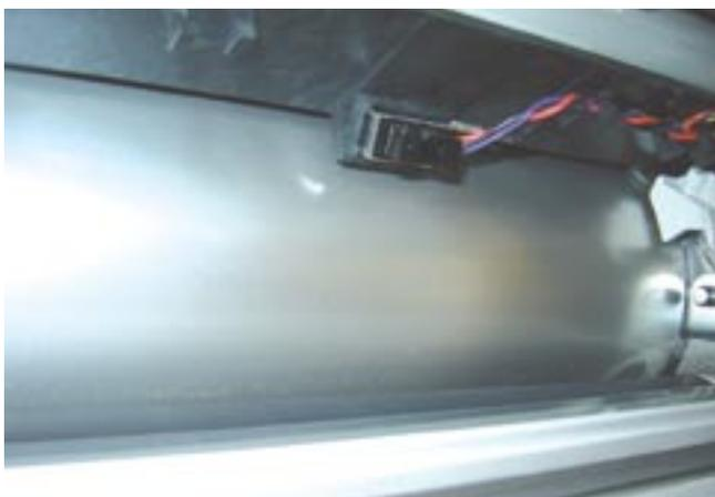
Рис. 2. Печатающий цилиндр Phaser 8550: печать при температуре 60°C позволяет работать с более широким спектром материалов, чем на «лазернике», который печатает при t° 180–220°C
