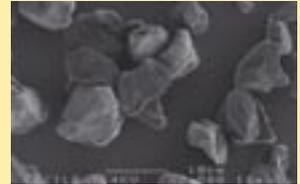
«Обычный» тонер, получаемый плавлением, распылением и просеиванием
