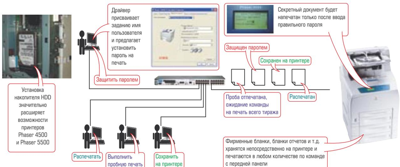
Рис. 1. Специальные функции коллективной печати Phaser 4500 и Phaser 5500
